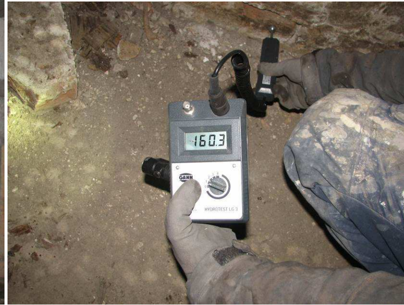
Kuva 2. Pinta-arvo kellarin seinän alaosassa osoittaa märkiä lukemia (~160/200)
